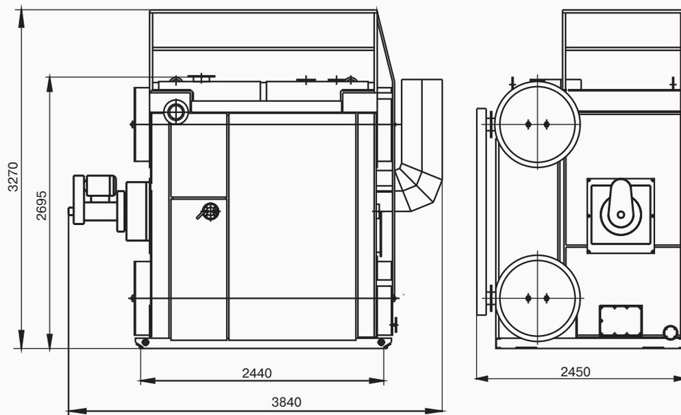
Котел предназначен для нагревания воды, находящейся под давлением не более 0,6 МПа (6 кгс/см<sup>2</sup>), до температуры не выше 95°С, используемой в закрытых системах теплоснабжения на нужды отопления, вентиляции, горячего водоснабжения (только через водоводяной подогреватель), а также для технологических целей при сжигании природного газа, мазута или легкого жидкого топлива.
